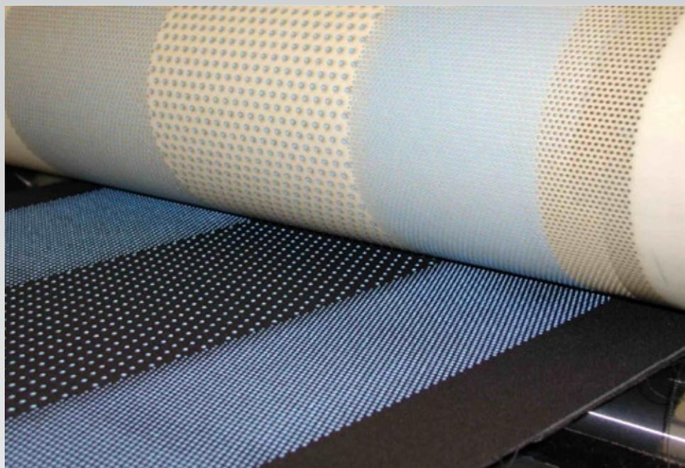
Unser neuestes Produkt das 3D Screen ermöglicht neue Applikationen und Einsatzmöglichkeiten im Rotationsiebdruck. Die Einsatzmöglichkeiten sind nahezu unbegrenzt, das Sieb kann ganz individuell nach Kundenwunsch auch mit einer 3D Gravur produziert werden.
